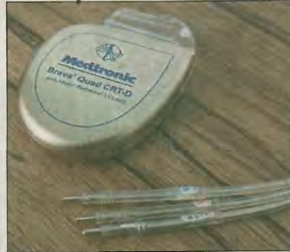
Ein Schrittmacher und einige Sondenkabel, deren Spitzen in den verschiedenen Herzmuskeln verankert werden. (Foto: Nopper)
